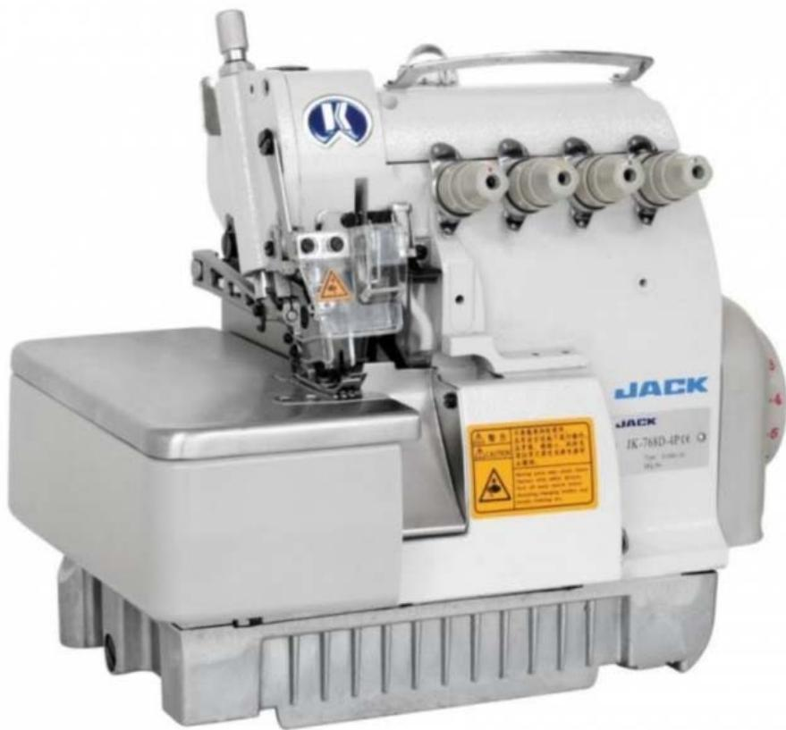
Remalladora industrial de 5 hilos con motor Servo incorporado dentro del cabezal.
